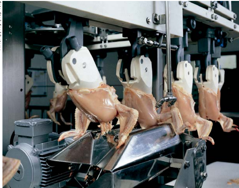
In een modulair ontworpen installatie worden kippen ontveld.
